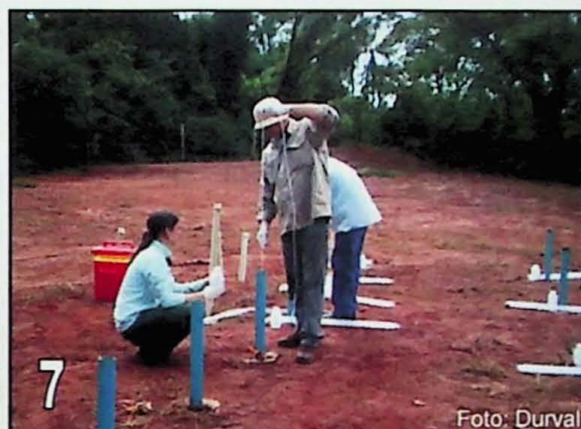
Fotos 7 e 8: Procedimento de amostragem dos poços de monitoramento com bailer e armazenamento da amostra em potes de 250mL identificados.
