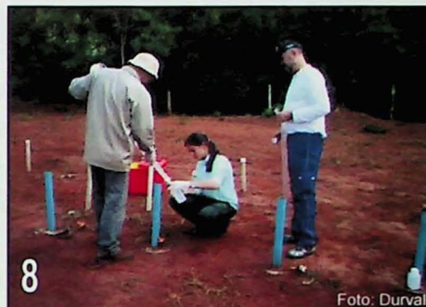
Fotos 7 e 8: Procedimento de amostragem dos poços de monitoramento com bailer e armazenamento da amostra em potes de 250mL identificados.
